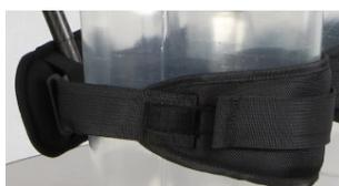
Lors de la **tension extrême** du matériel dans des positions proches du sol, l'exosquelette a été inconfortable au niveau des cuisses, parfois au point d'être qualifié comme **douloureux**. Les maraîchers ont également dû faire face à des **difficultés de maintien** au niveau des cuisses. Le système de fixation par fermeture autoagrippante n'a **pas été jugé suffisant**.
