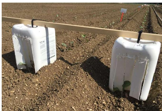
Piège à glu expérimental avec volets mobiles
